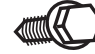
⑮ Tornillo de cabeza hexagonal (2) para la cubierta de la entrada del tubo de agua (5/8")*
